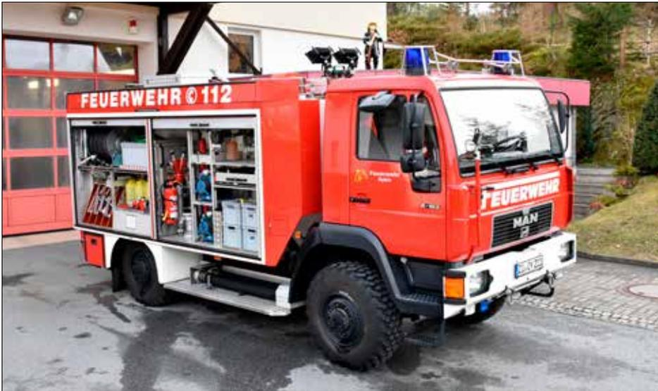
Das Tanklöschfahrzeug mit einer Nennförderleistung von 1600 Liter Wasser pro Minute wird gute Dienste leisten.
