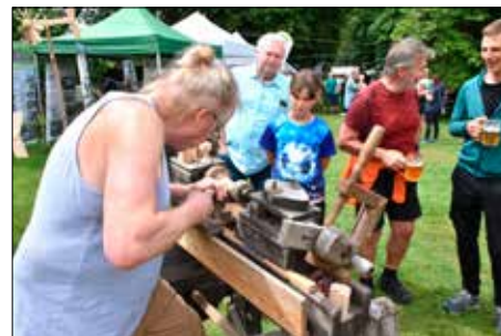
Die historische Spindelmaschine zum dreheln des Holzes wurde wie eine Nähmaschine mit den Füßen in Bewegung gesetzt
