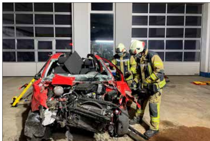
Spreizen für eine große Seitenöffnung mithilfe der neuen Akku-Geräte
