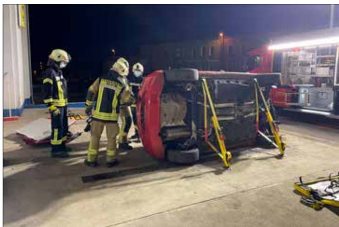
Sicheres Arbeiten am Fahrzeug mithilfe des neuen Stab-Fast-Systems
